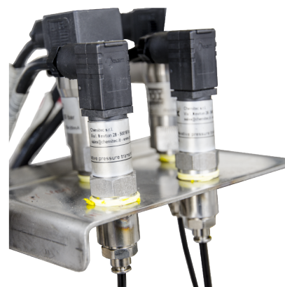
BATTERIA DI TRASDUTTORI DI PRESSIONE
